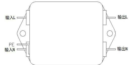
连接方式请使用 6.3mm 插簧连接，如果使用焊锡连接请注意焊接时间
